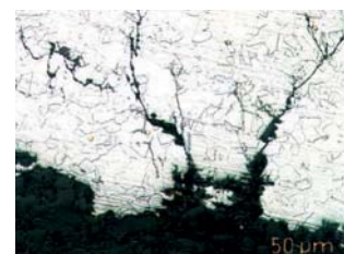
Příklad trhliny způsobené transkrystalickou korozi napětím v plechu 1.4401, který byl vystaven značnému účinkům chlóru.
